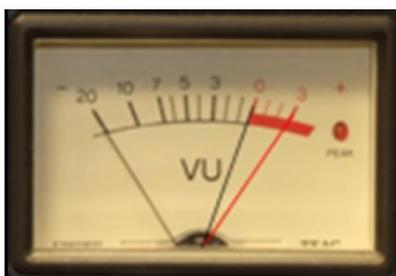
Zero VU: + 4 dBm (+ 4 dBm a 600 ohms)
